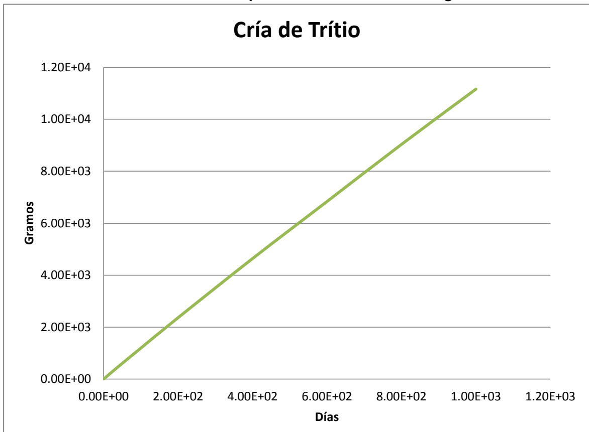
Figura 5-11: Modelo del CFNS con multiplicador de berilio
