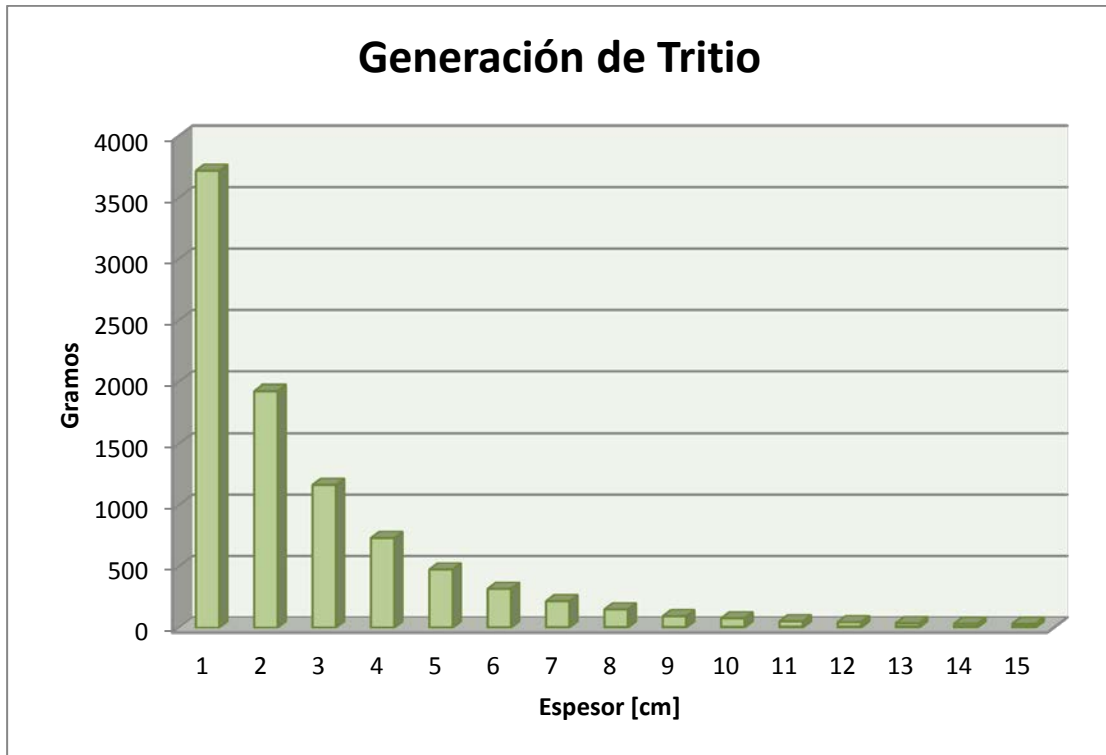
Figura 5-23: Gráfica de la generación del tritio en función del grosor o espesor de la cobija (cilindro externo)
