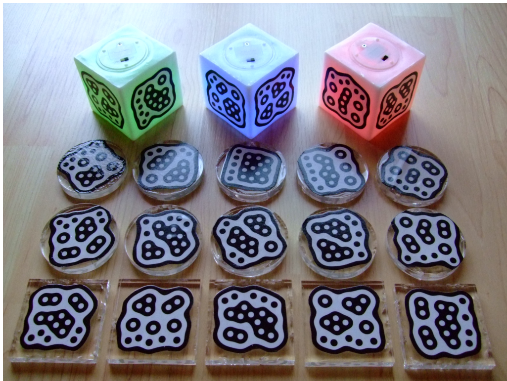
Figura 2.2: Fiducials en elementos físicos para usarse en la Reactable [22]
