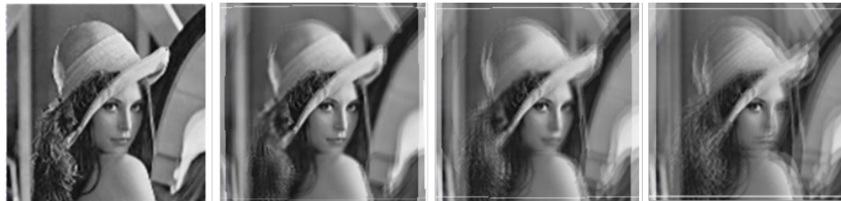
Figura 5.8: Efectos de la curvatura del campo
