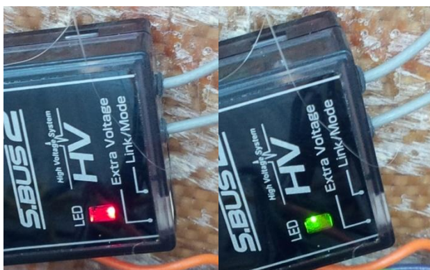
Fig. 7.4. Indicador de enlace con el equipo de radio control.
