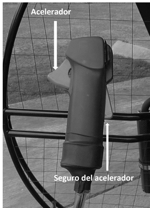
Fig. 3.3. Actuador manual del acelerador del motor.
