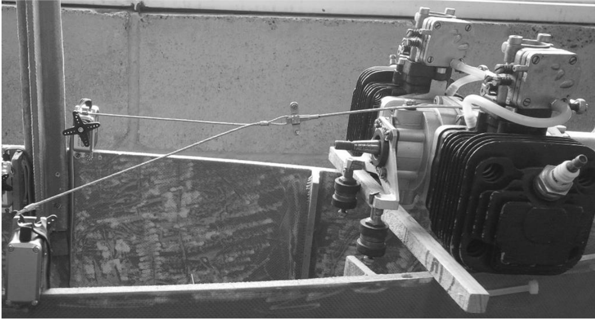
Fig. 7.5. Actuadores conectados al acelerador del motor.
