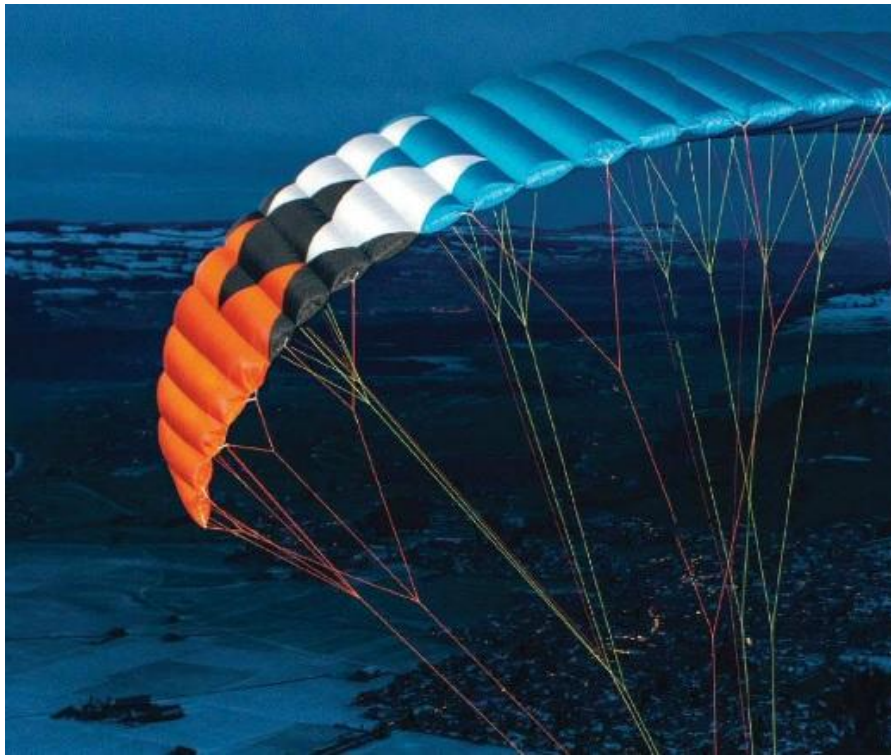
Fig. 3.7. Ejemplo de líneas en cascada. Vista posterior del parapente.
