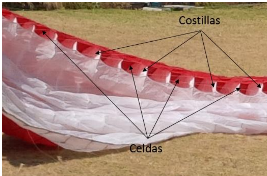
Fig. 1.3. Celdas y costillas de separación de superficies de un parapente moderno.
