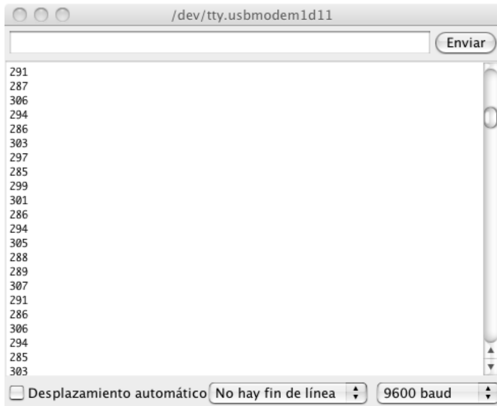
Figura 2.5: Monitor serial con los datos recuperados del microcontrolador.
