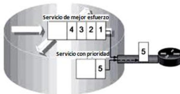
**Figura 4.4** Sistema de encolamiento con paquetes de alta prioridad.
