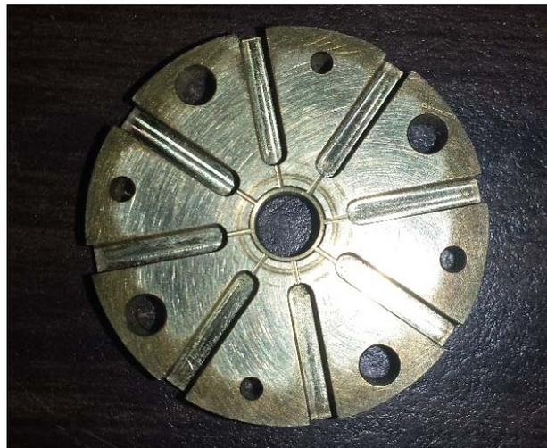
Figura 4. 19 Vista superior del dispositivo de montaje fabricado en latón
