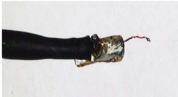
Figura 4. 26 Muestra de enlace de polarización con cable 28 AWG y alambre magneto
