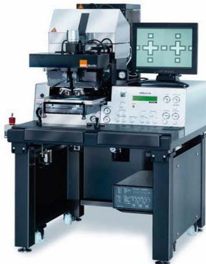
Figura 4. 3 Equipo de alineación de obleas, cortesía de SUSS MicroTec [2]
