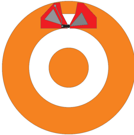
Figura 4.2: Vista superior del Desplazador de 1 Stub con interruptor MEMS
