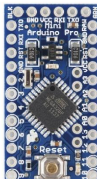
Figura 4.34. Tarjeta Arduino Pro-Mini con micro-controlador ATmega328 [62].
