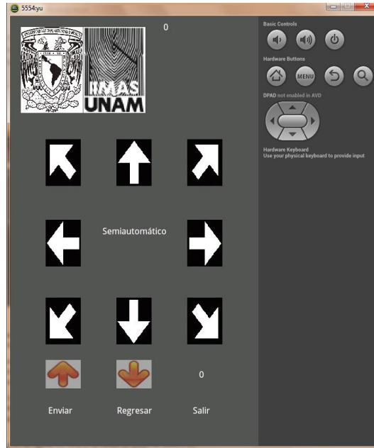
Figura 3.29. Pantalla de “Control Semiautomático” de la aplicación de comunicación para el control de desplazamiento de la plataforma móvil.
