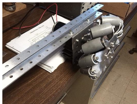
Figura A.27. Conexión del Toughbox Mini y rueda omnidireccional a la canaleta para la plataforma.
