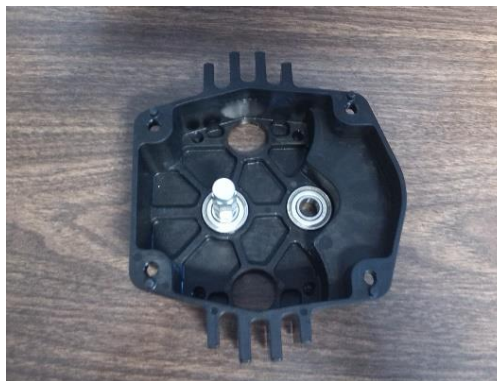
Figura A.3. La Mini tapa del Toughbox Mini con la pequeña barra del eje hexagonal colocado en el balero.
