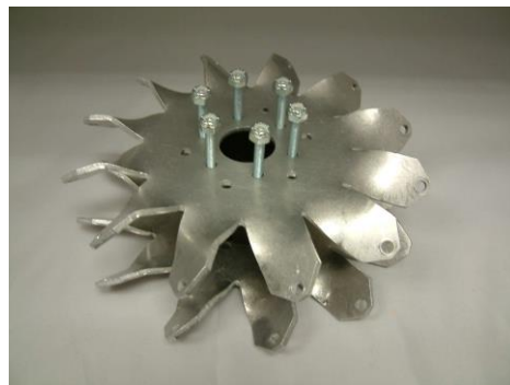
Figura A.16. Segunda placa lateral colocada y las tuercas con los tornillos centrales.
