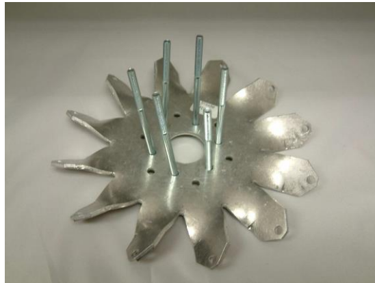
Figura A.14. Placa lateral y tornillos desde los orificios más cercanos al orificio central.
