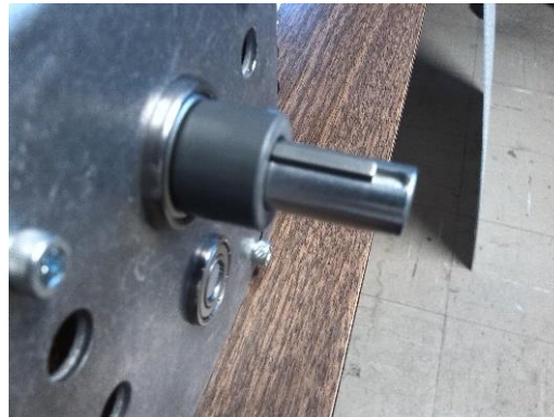
Figura A.21. Colocación de la barra aseguradora en la ranura de la flecha.
