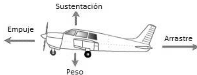
Figura 2. Fuerzas que actúan en un aeroplano.
