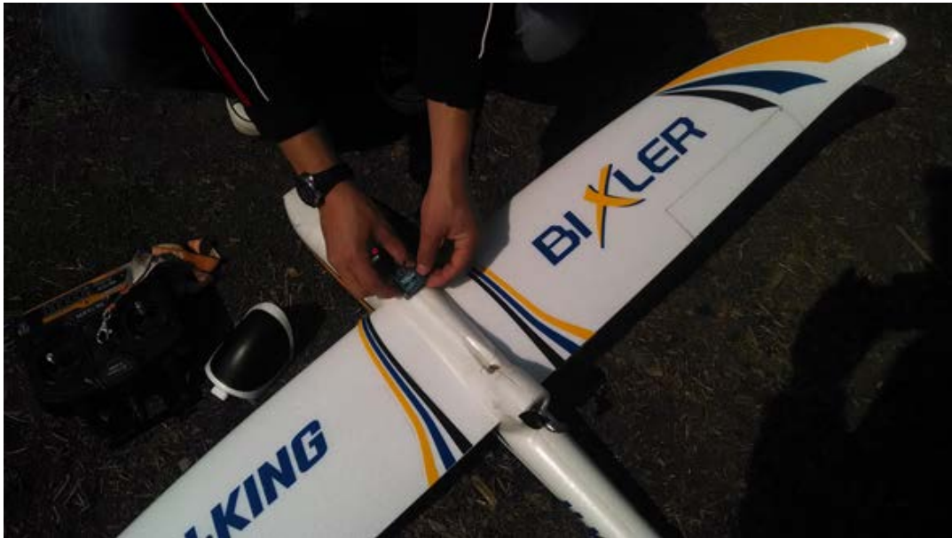
Figura 55. Montaje de las tarjetas desarrolladas.
