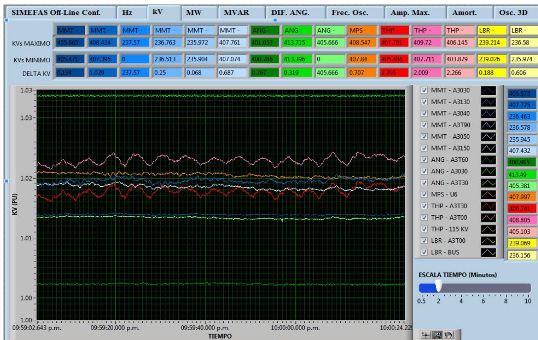
Figura 4.10. Tensión contra tiempo especificando valores máximos y mínimos de tensión.
