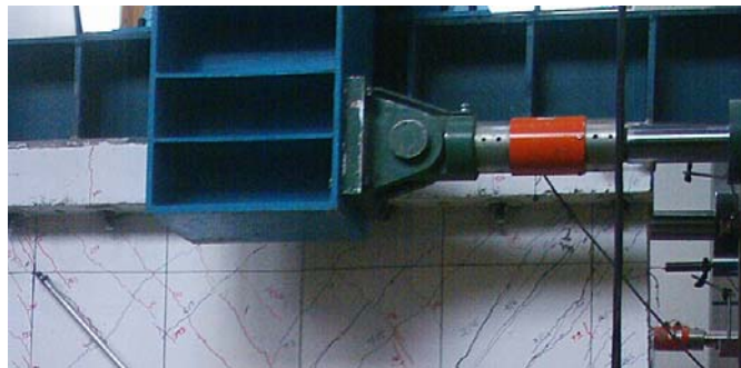
Figura 2.13 Aplicación de la carga horizontal cíclica
