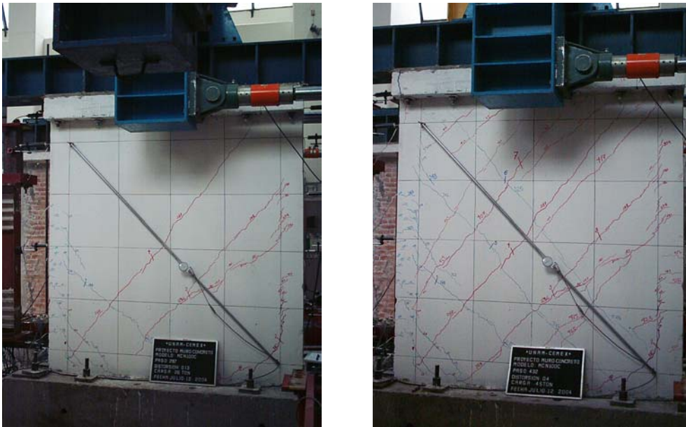
Figura 4.28 Modelo en proceso inicial (izq) y proceso intermedio (der) del ensaye.
