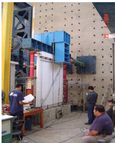
Figura 3.2 Posición final del muro antes del ensaye
