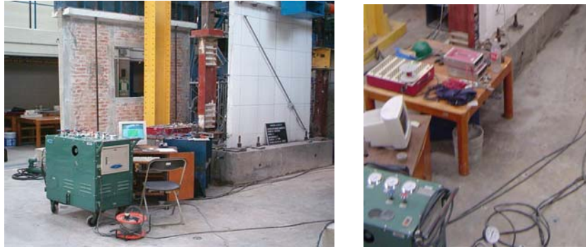
Figura 2.16 Equipo programable (TDS) y caja de interruptores
