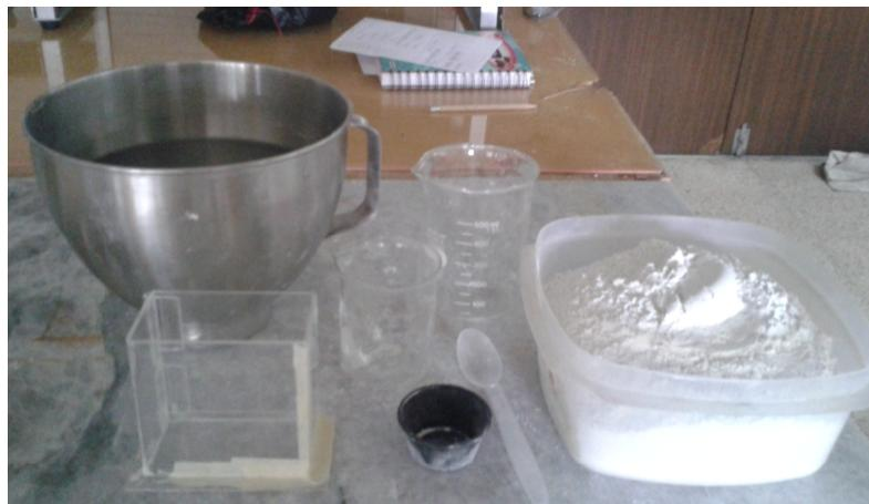
Figura 3.10: Elaboración de la pasta de cemento
