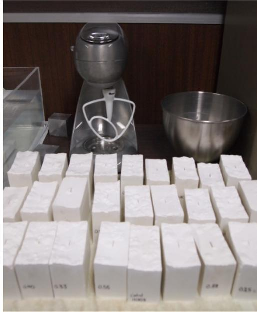
Figura 3.11: Probetas de pastas de cemento
