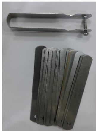
Figura 3.12: Calibradores para el ancho de las fracturas
