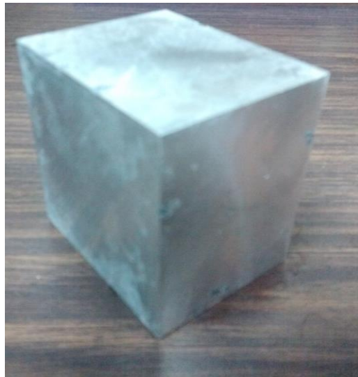
Figura 4-7. Cubo de aluminio utilizado en las inspecciones radial y abanico.
