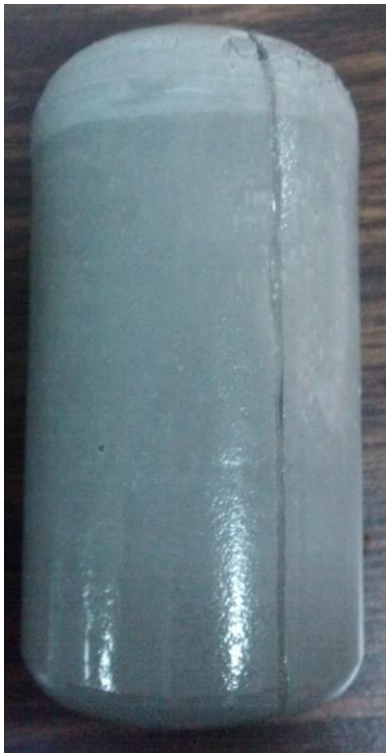
Figura 4-14. Probeta de concreto utilizada en las inspecciones en abanico.
