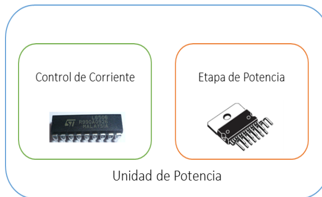
Figura 2-11. Etapa de potencia implementado en el diagrama de bloques del sistema de control electrónico.
