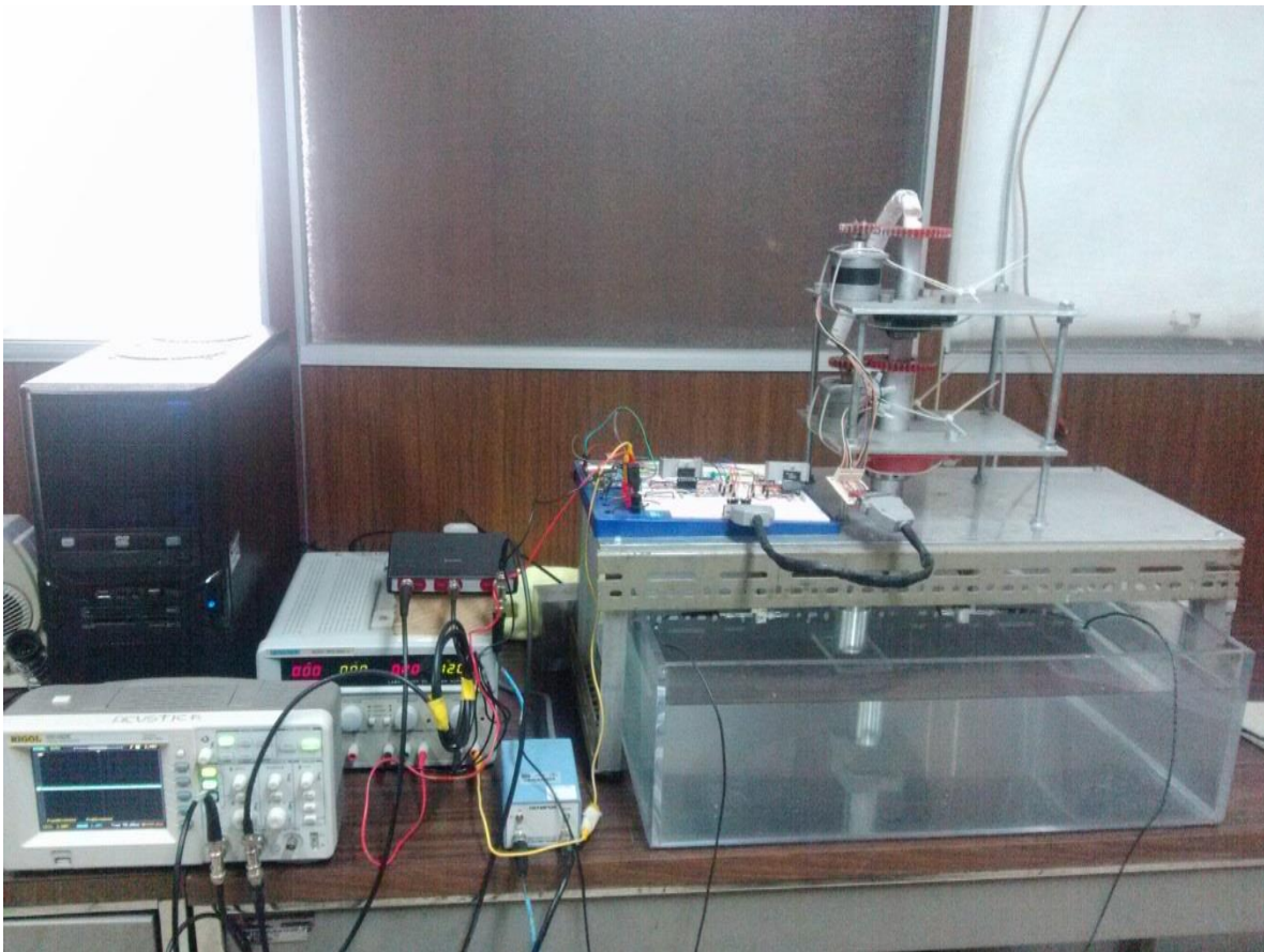
Figura 4-1. Sistema de adquisición de señales de ultrasónico integrado por completo.
