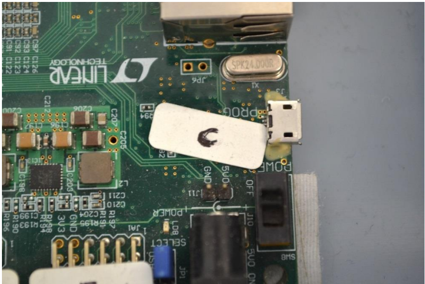
Figura 55. Conector Prog, además de estar indicado en la tarjeta tiene una etiqueta.
