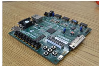
Figura 1. Tarjeta FPGA que servirá como cerebro del control
