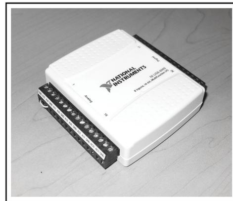
figura 3.9 Dispositivo de adquisición de datos
