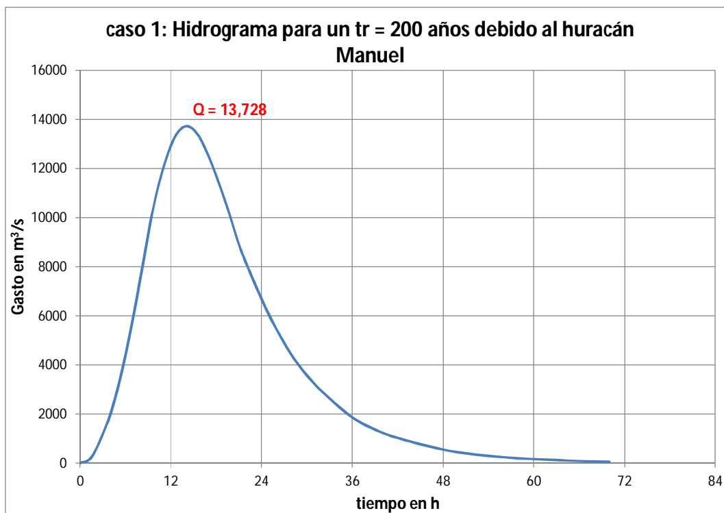
Figura 3.6. Hidrograma de diseño de la Estación hidrométrica la Parota, registros hasta el 2003 Fuente: elaboración propia
