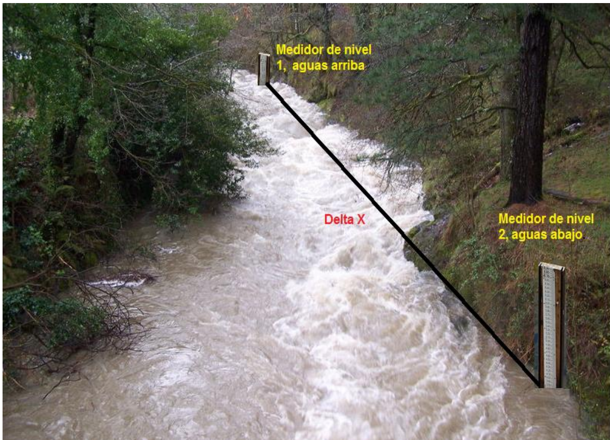
Lámina 3.2 Esquematización del procedimiento de aforo con medidor de nivel
