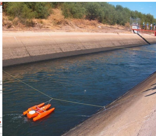
Lámina 2.23 Aforo con Perfilador acústicos de efecto Doppler montado en un barquito
