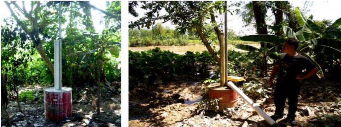
Lámina 2.24 Esquema y muestra de la forma de instalación de estos equipos utilizados, cuando no hay elementos fijos en el cauce.
