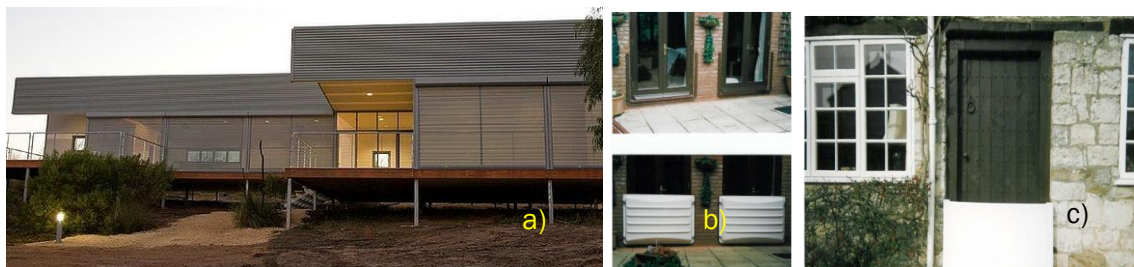
Figura 3.4 Ejemplos de las medidas de resiliencia ante inundaciones en construcciones urbanas propuestas por el Reino Unido: a) construcción sobre-elevada, b) medidas de protección contra el agua, c) medidas de impedimento de paso del agua
