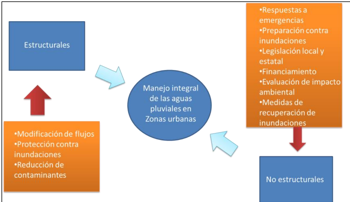
Ilustración 3.1 Manejo integral del agua pluvial
