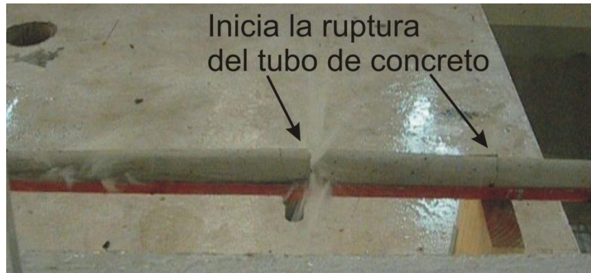
Figura 4.24. Inicio de la ruptura y de la fuga de agua en el tubo de concreto.
