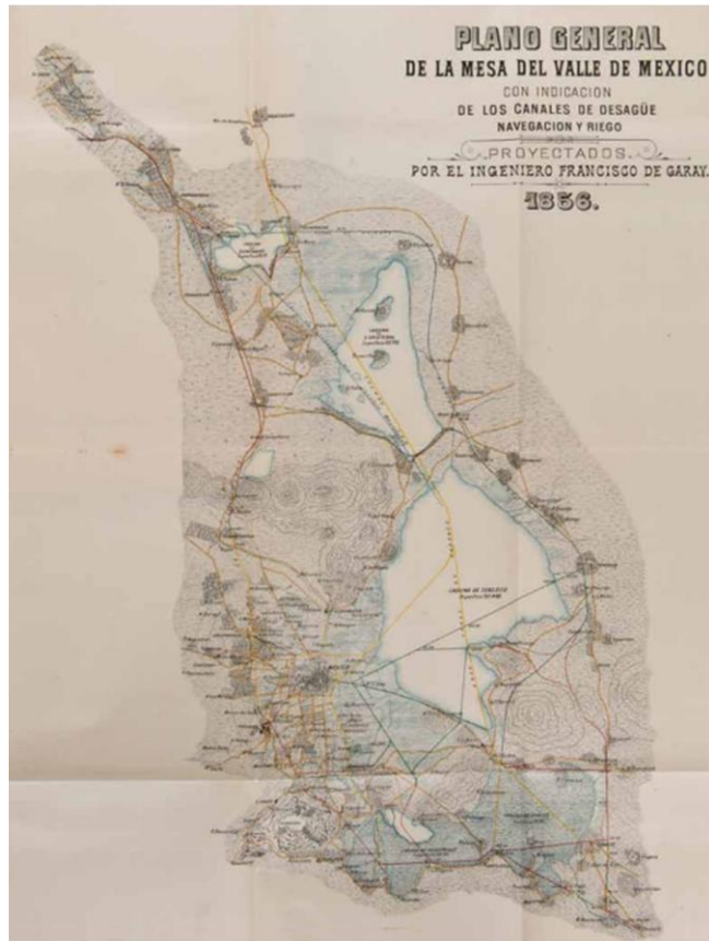
Figura 3.3. Plano general de la mesa del valle de México con indicación de los canales de desagüe, navegación y riego proyectado por el Ing. Francisco de Garay, 1856.
