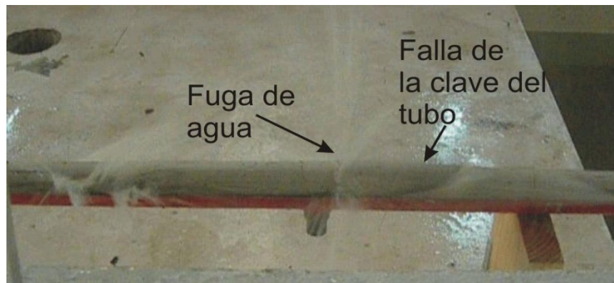
Figura 4.25. Inicia el levantamiento de la clave del tubo debido a la sobrepresión.
