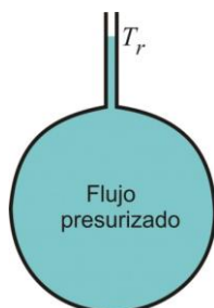
Figura 4.2. Ranura de Preissmann en la clave de un tubo presurizado.
