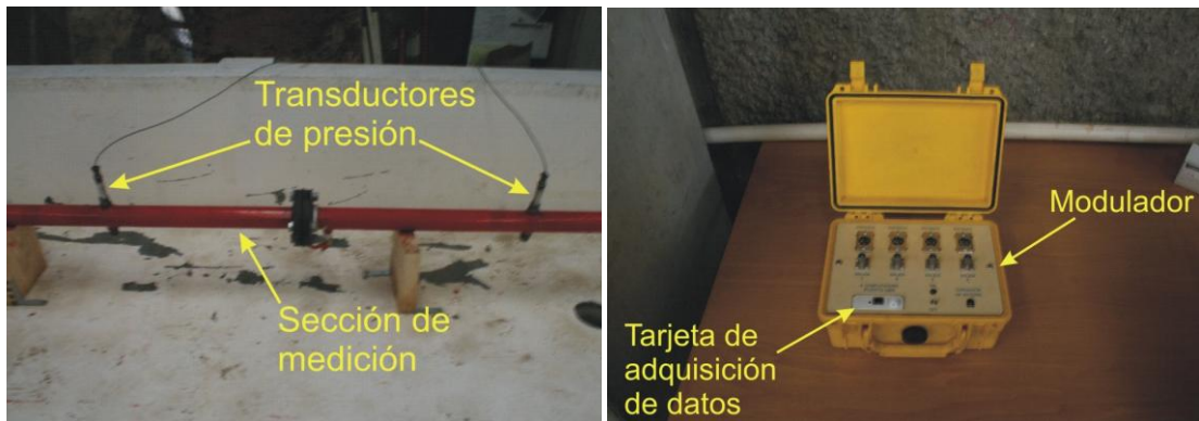
Figura 4.10. Izquierda: transductores instalados en la sección de medición. Derecha: modulador y tarjeta de adquisición de datos
