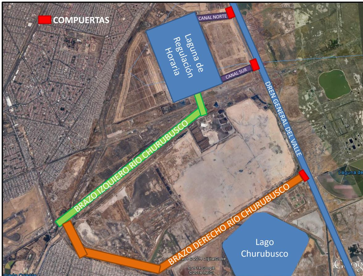
Figura 7.2. Localización de las compuertas en los Brazos Derecho e Izquierdo del río Churubusco.
