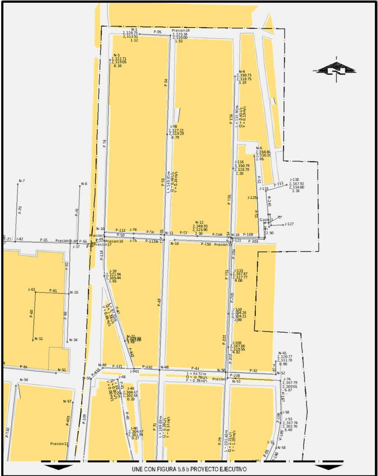
**Figura 5.8 Funcionamiento hidráulico baja presión 9:00 A.M. VRP Barranco. Presión consigna  $P=1.50$  [kg/cm<sup>2</sup>].**
