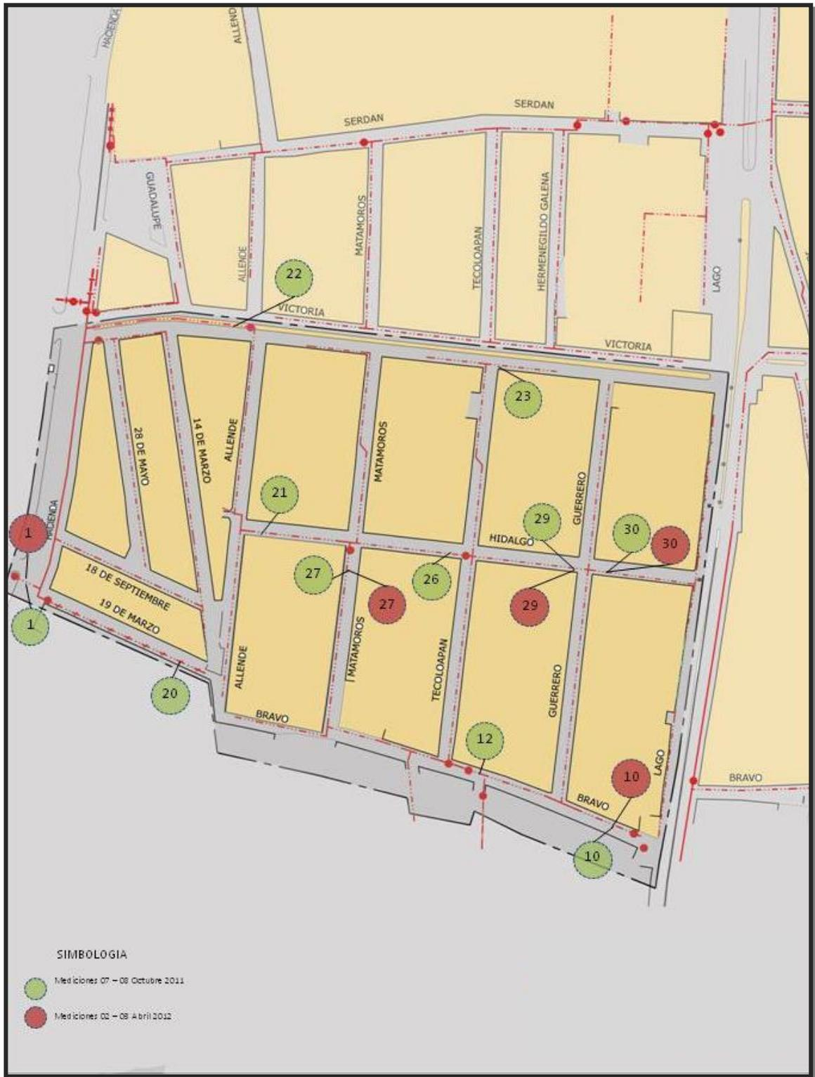
**Figura. 3.23. Puntos de medición de presión y gastos CVRP
