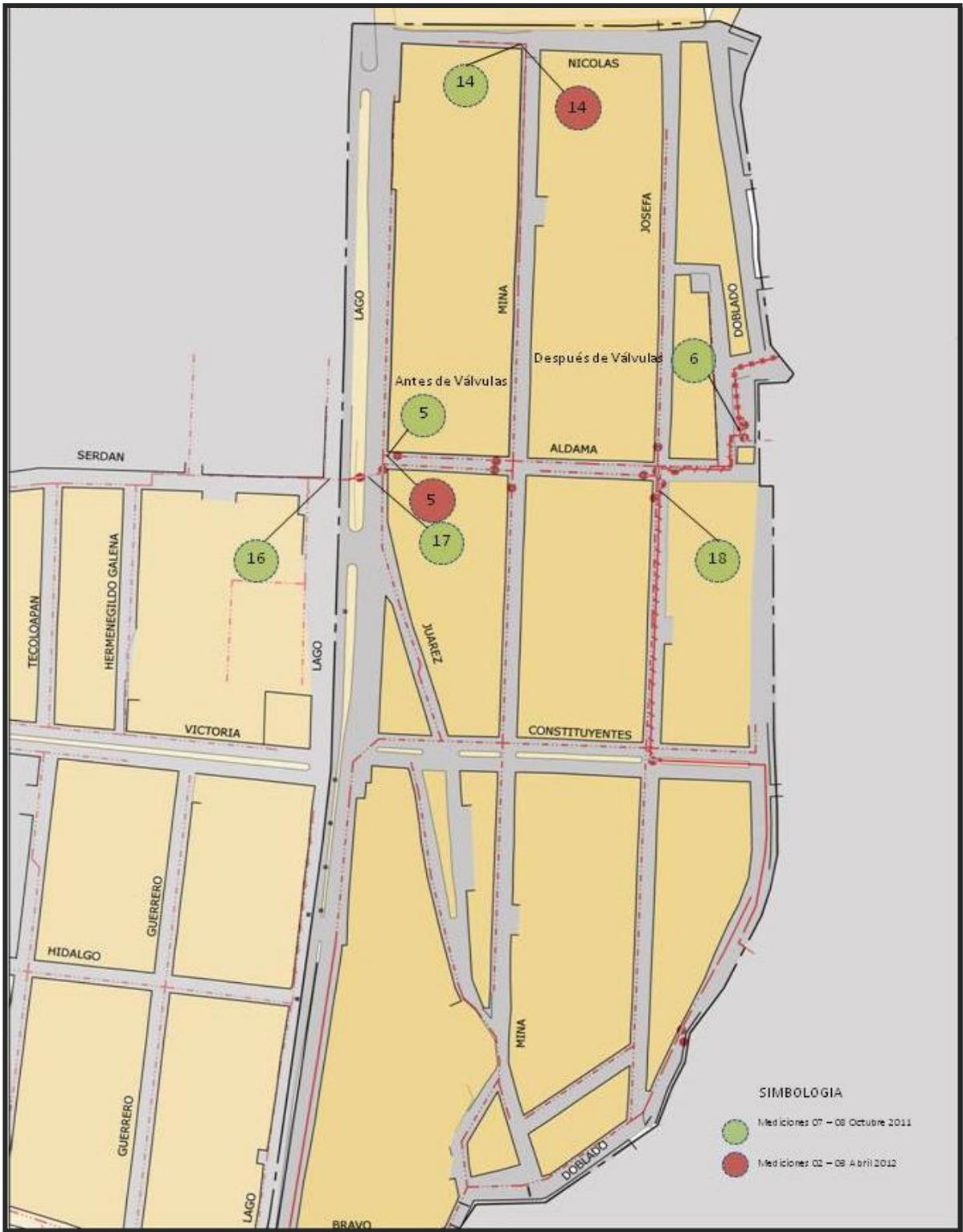
**Figura. 3.24. Puntos de medición de presión y gastos CVRP
