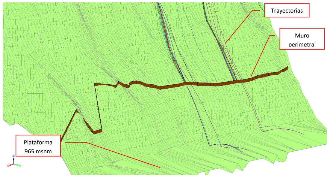
Figura 6.24 Trayectorias de los fragmentos rocosos para la zona de lanzamiento 1.
