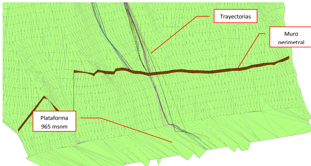
Figura 6.34 Trayectorias de los fragmentos rocosos para la zona de lanzamiento 5.
