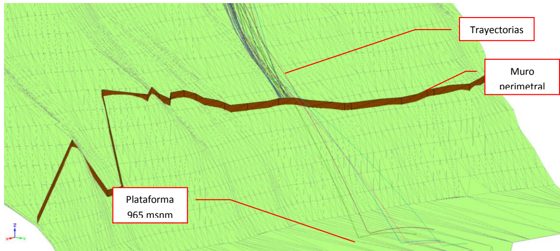
Figura 6.30 Trayectorias de los fragmentos rocosos para la zona de lanzamiento 3B.
