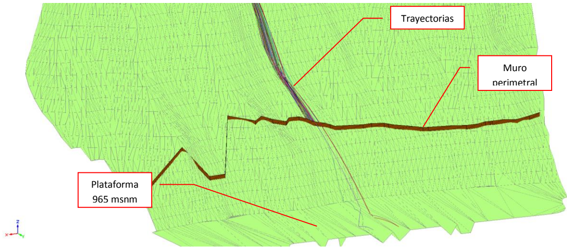
Figura 6.36 Trayectorias de los fragmentos rocosos para la zona de lanzamiento 6.
