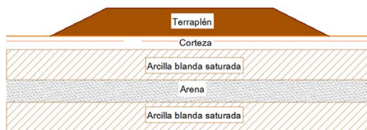
Figura 2.5 Configuración típica de estratos de suelo bajo un terraplén
