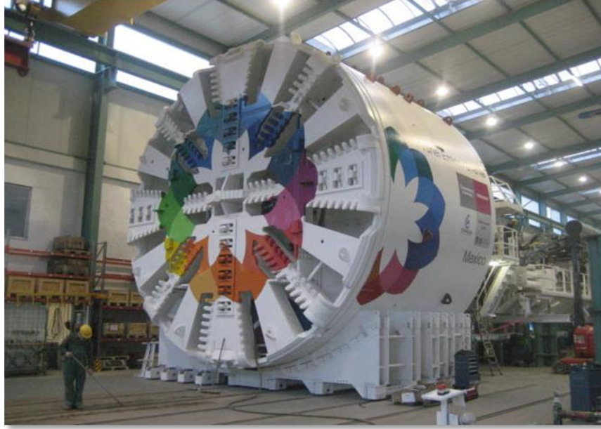
Figura 10. TBM ensamblada (CONAGUA, 2011)
