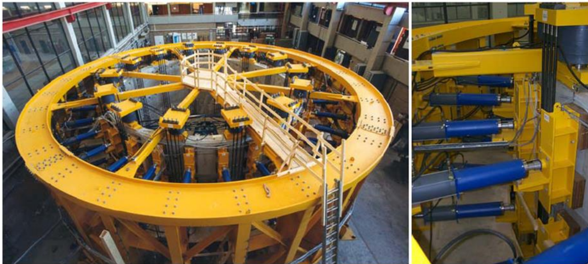
Figura 19. Modelo experimental (Lutikholt, 2007): a) vista general del ensaye; b) detalle de las vigas de repartición para la transmisión de la carga radial
