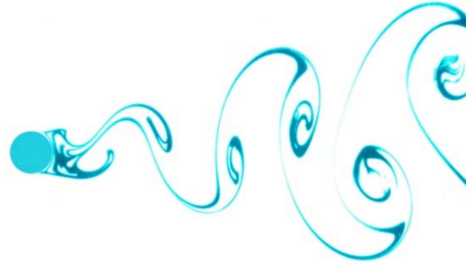
Figura A. 1. Vórtices de Von-Kármán
