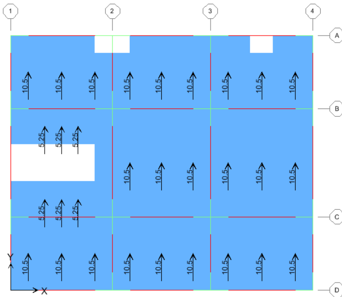
Figura 3.7 MEF Distribución de fuerzas de piso en firme con el programa ETABS.
