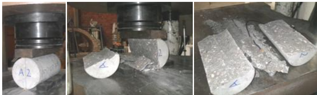
Fig 5.5 Ensayo de cilindros a tensión por compresión diametral, antes y después de la prueba.
