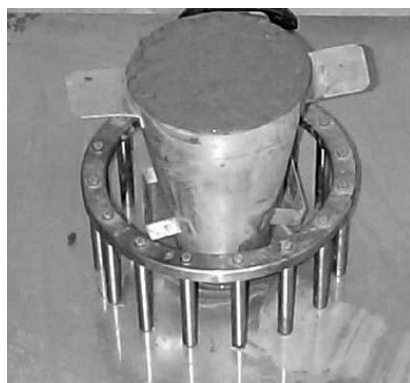
Fig 5.1 Ensayo del “anillo J” (ASTM C-1621, 2009).
