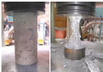
Fig 5.4 Ensayo de cilindros a compresión simple, antes y después de la prueba.
