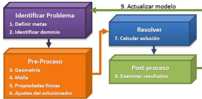
Figura 4. 3 Diagrama de flujo del proceso de modelación con MFC.
