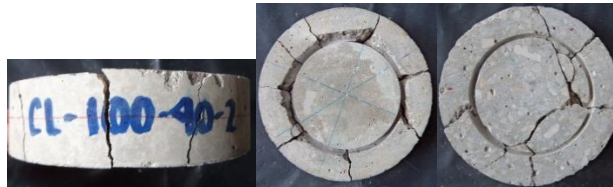
Figura 4.2 Modo de falla en probetas de concreto sin fibra, con 40 mm de altura y 100 mm de diámetro de ranura
