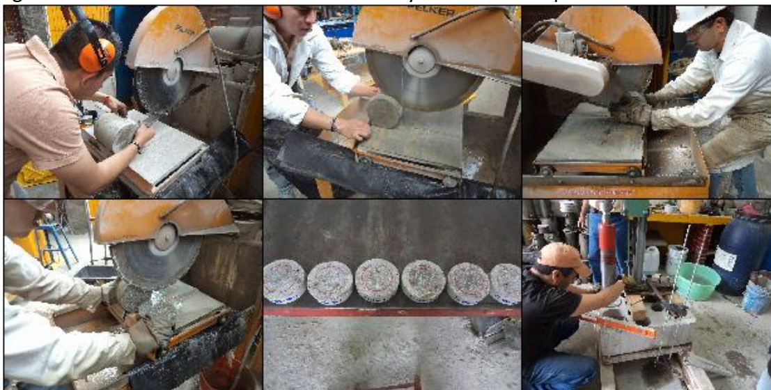
Figura 3.20 Preparación de especímenes tipo Luong
