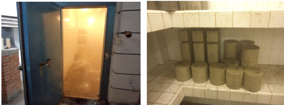
Figura 3.18 Almacenamiento y curado de especímenes
