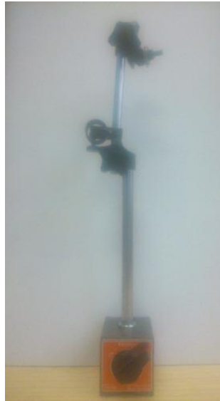
Figura 3.34 Base magnética para montaje de transductores de desplazamiento
