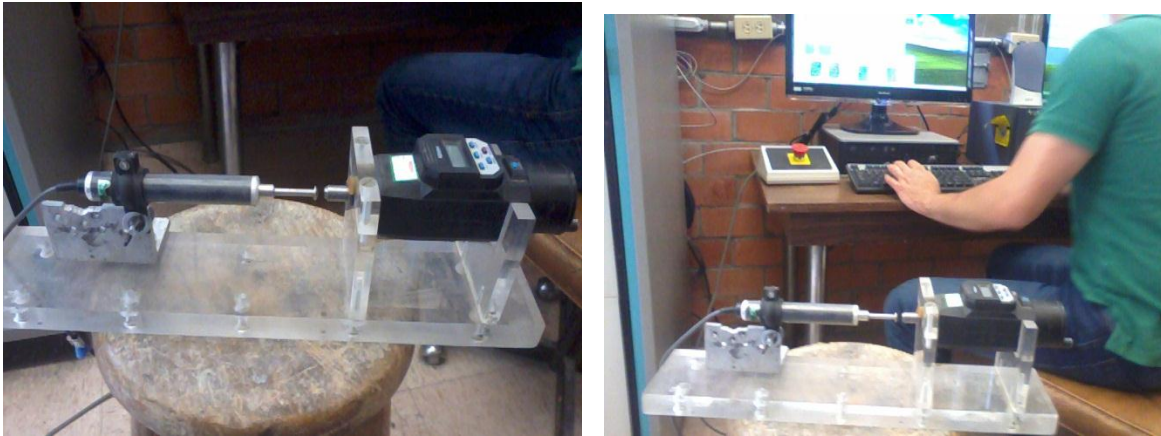
Figura 3.30 Calibración de transductores de desplazamiento
