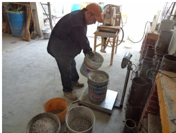
Figura 3.8 Dosificación de materiales
