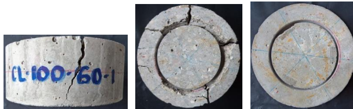
Figura 4.4 Modo de falla en probetas de concreto sin fibra, con 60 mm de altura y 100 mm de diámetro de ranura
