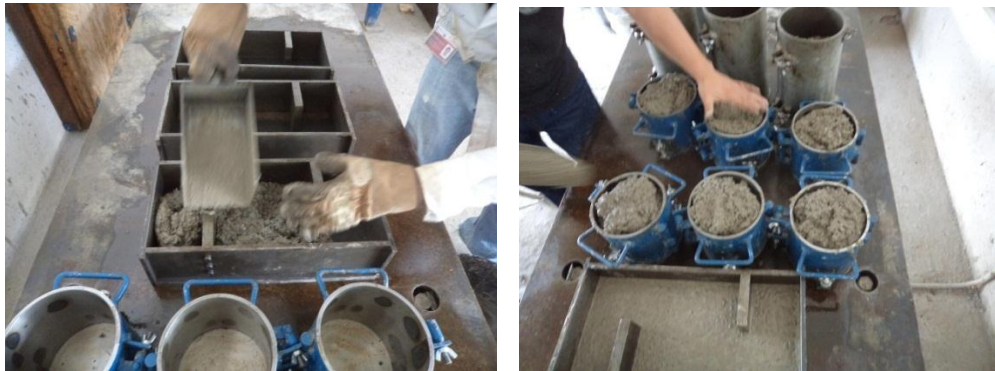
Figura 3.16 Moldeado y vibrado de muestras
