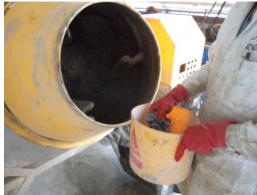
Figura 3.13 Adición de fibras de acero Dramix RC6535BN
