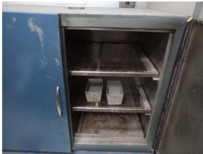
Figura 3.7 Secado de agregados en horno
