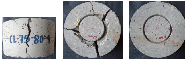
Figura 4.7 Modo de falla en probetas de concreto sin fibra, con 80 mm de altura y 75 mm de diámetro de ranura
