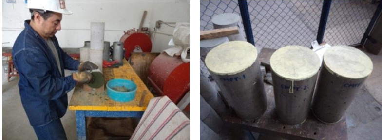
Figura 3.19 Cabeceo con azufre en cilindros para ensayos a compresión
