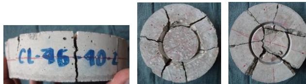
Figura 4.3 Modo de falla en probetas de concreto sin fibra, con 40 mm de altura y 75 mm de diámetro de ranura
