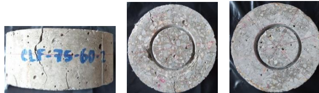
Figura 4.11 Modo de falla en probetas de concreto con fibra, con 60 mm de altura y 75 mm de diámetro de ranura
