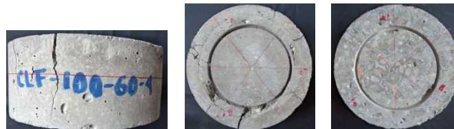
Figura 4.10 Modo de falla en probetas de concreto con fibra, con 60 mm de altura y 100 mm de diámetro de ranura
