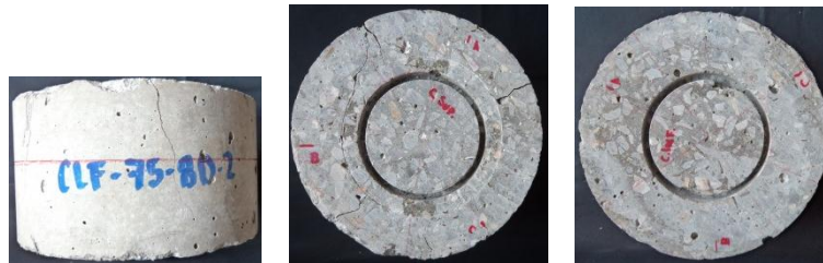
Figura 4.13 Modo de falla en probetas de concreto con fibra, con 80 mm de altura y 75 mm de diámetro de ranura
