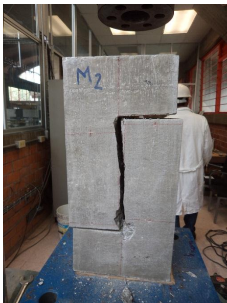
Figura 4.14 Modo de falla típico en bloques sin fibra
