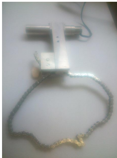
Figura 3.35 Cadena con transductor de desplazamiento para medir deformación diametral
