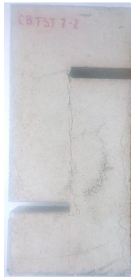
Figura 5.7 Modo de falla típico en bloques tipo “Z”, CRF acero Dramix RC 65 35 BN 60 kg/m 3
