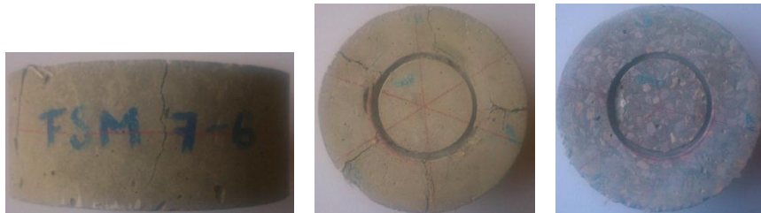
Figura 5.4 Modo de falla en probetas de CRF, fibras sintéticas tipo MAC-MATRIX 7 kg/m 3
