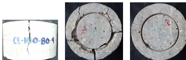
Figura 4.6 Modo de falla en probetas de concreto sin fibra, con 80 mm de altura y 100 mm de diámetro de ranura
