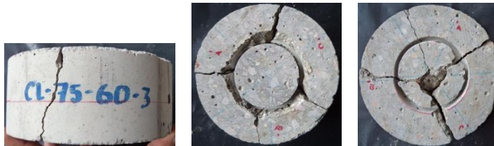
Figura 4.5 Modo de falla en probetas de concreto sin fibra, con 60 mm de altura y 75 mm de diámetro de ranura
