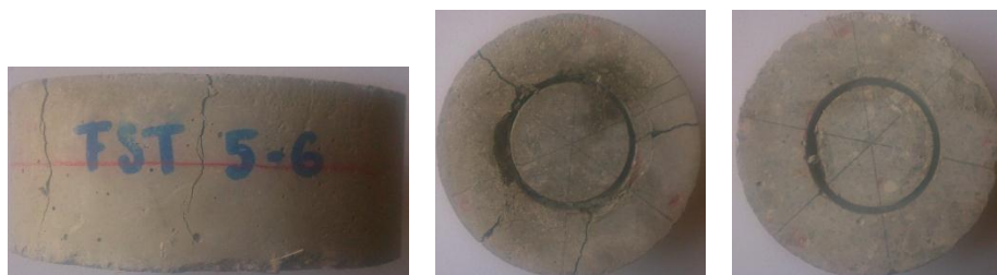
Figura 5.5 Modo de falla en probetas de CRF, fibras sintéticas tipo TUF-STRAND 5 kg/m 3
