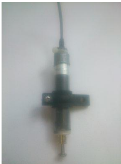
Figura 3.33 Transductor de desplazamiento con un rango de 10 mm
