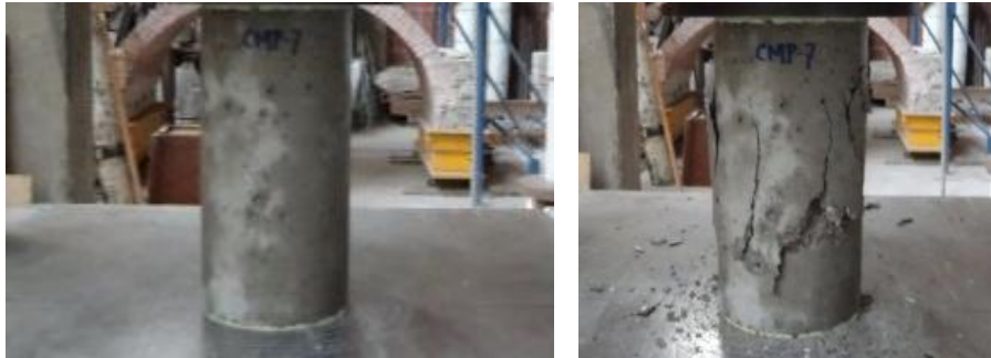
Figura 3.37 Ensayo a compresión
