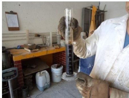
Figura 3.12 Dosificación de aditivo Puzzolith 322N
