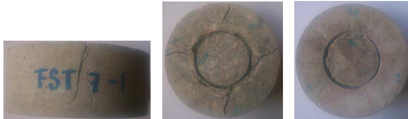
Figura 5.3 Modo de falla en probetas de CRF, fibras sintéticas tipo TUF-STRAND 7 kg/m 3
