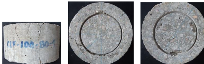
Figura 4.12 Modo de falla en probetas de concreto con fibra, con 80 mm de altura y 100 mm de diámetro de ranura
