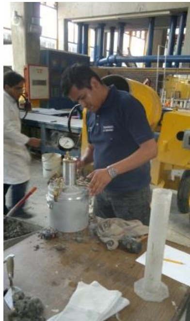
Fotografía 25 (Muestra la realización del la prueba contenido de aire al concreto)
