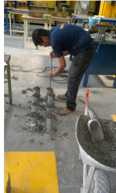
Fotografía 24 (Muestra la realización de las probetas que se ensayaran)
