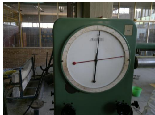
Fotografía 66 (muestra resultado a la tensión a 28 días de 5750kg)
