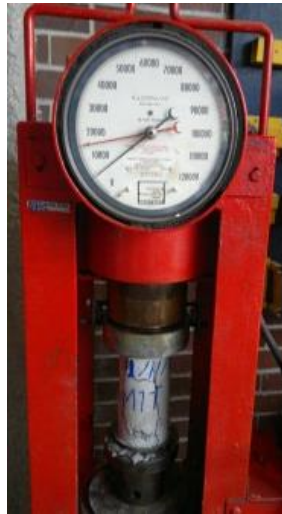
Fotografía 29(muestra resultado a 7 días de 15000kg)
