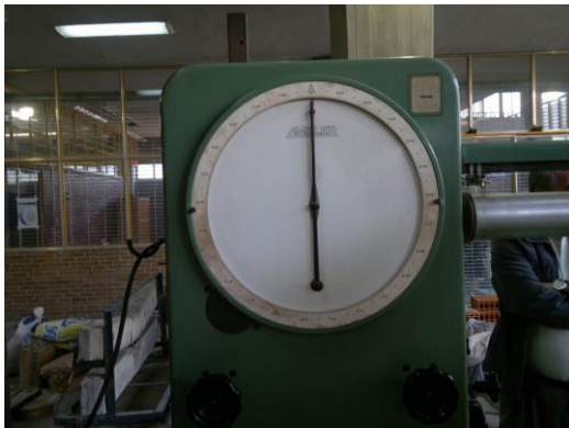
Fotografía 47 (muestra resultado a la flexión a 28 días de 100kg)
