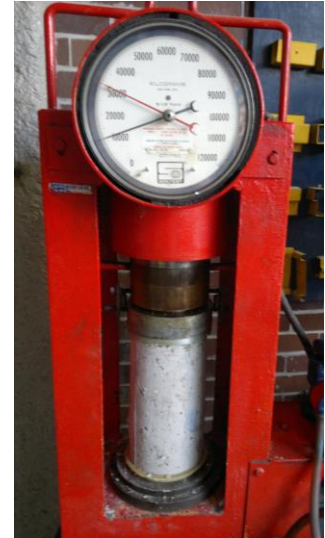
Fotografía 62 (muestra resultado a la compresión a 28 días de 30800kg)
