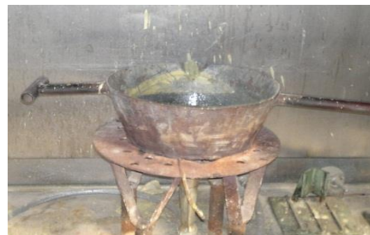
Fotografía 27 (Muestra la preparación del sílice para cabecear los cilindros para sus ensayos)
