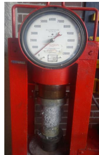
Fotografía 44 (muestra resultado a 7 días de 1200kg)
