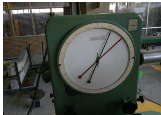
Fotografía 50 (muestra resultado a la tensión a 28 días de 1360kg)
