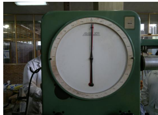
Fotografía 48 (muestra resultado a la flexión a 28 días de 200kg)
