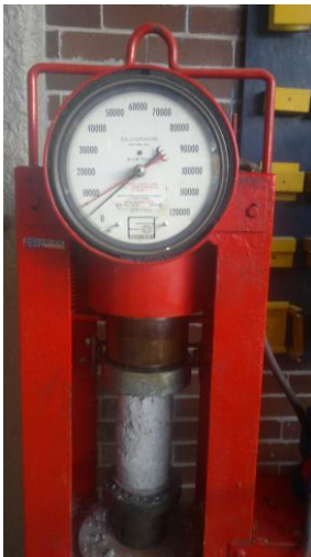
Fotografía 51 (muestra resultado a 7 días de 6400kg)
