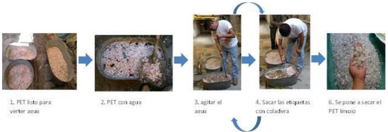
Figura 2 (muestra el procedimiento de lavado de PET triturado)
