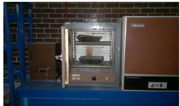
Fotografía 17 (muestra la colocación de la grava en el horno para determinar su porcentaje de absorción)
