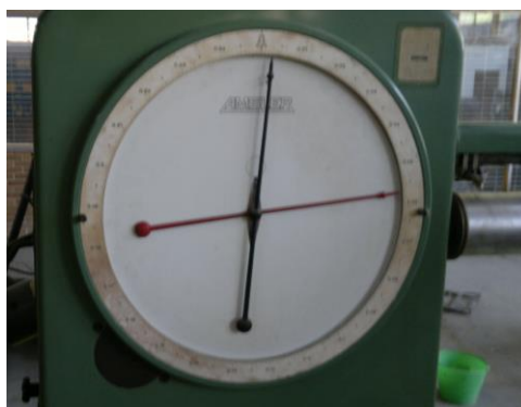
Fotografía 65 (muestra resultado a la tensión a 28 días de 5700kg)
