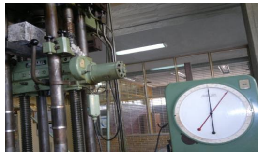
Fotografía 35 (muestra resultado a 28 días de la flexión 2500kg)
