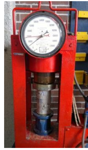
Fotografía 31 (muestra resultado a 14 días de 82000kg)
