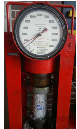
Fotografía 54 (muestra resultado a 14 días de 6800kg)
