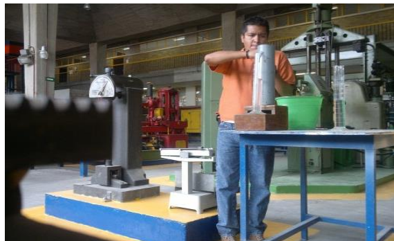
Fotografía 16 (muestra la determinación de la densidad la grava)
