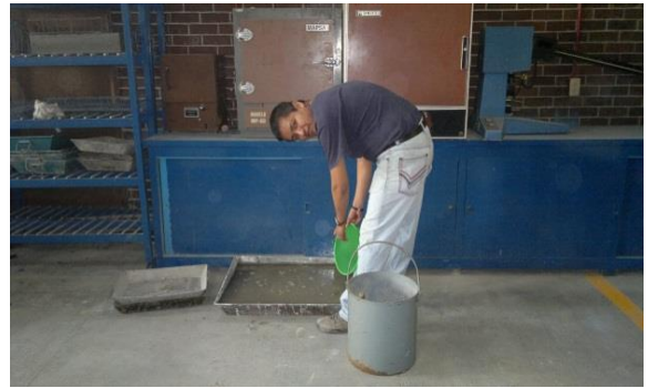
Fotografía 13 (muestra la saturación de la grava)
