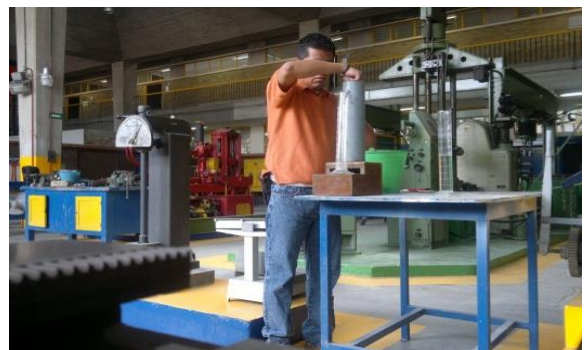
Fotografía 15 (Muestra el procedimiento final para determinar la densidad de la grava)
