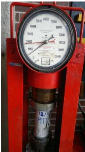
Fotografía 32 (muestra resultado a 28 días de 19400kg)
