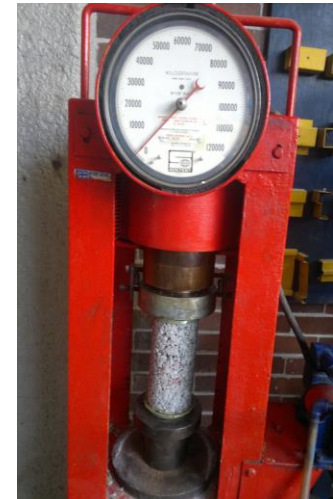
Fotografía 42 (muestra resultado a 7 días de 1200kg)
