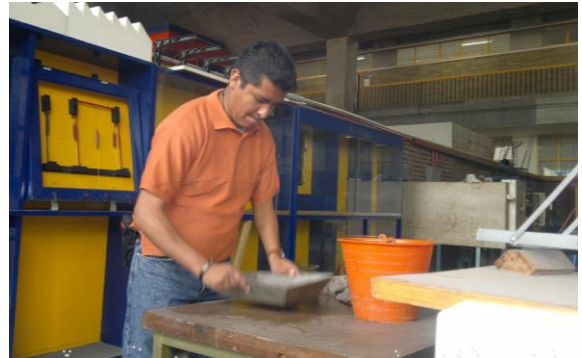
Fotografía 6 (muestra como se esta quitando la humedad para dejar saturado el material)
