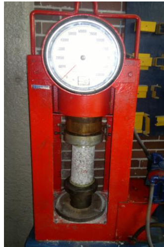
Fotografía 41 (muestra resultado a 7 días de 1200kg)
