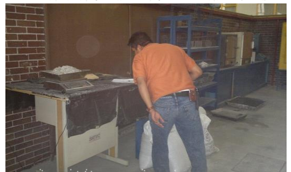
Fotografía 12 (muestra el peso de la arena fina para determinar su módulo de finura)
