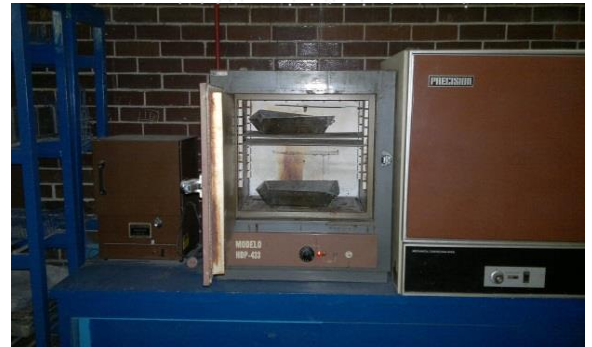
Fotografía 10 (muestra el horno con la arena para determinar su grado de absorción des pues de la bese pesado en estado SSS y seco)
