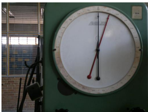
Fotografía 58 (muestra resultado a la flexión a 28días de 1260kg)
