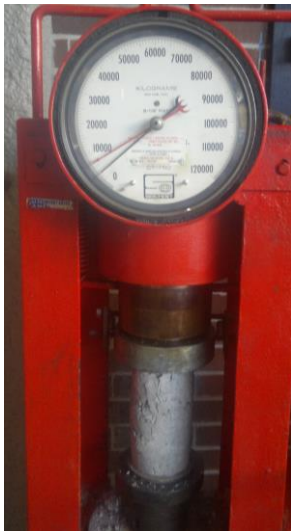
Fotografía 55 (muestra resultado a 28 días de 6000kg)
