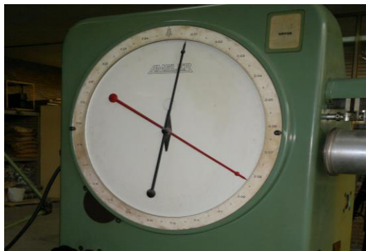
Fotografía 36 (Muestra los resultados a la tensión a 28 días 9350 kg)
