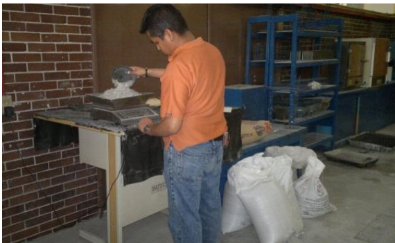
Fotografía 20 (se pesan 200gr de PET para determinar posteriormente su densidad)
