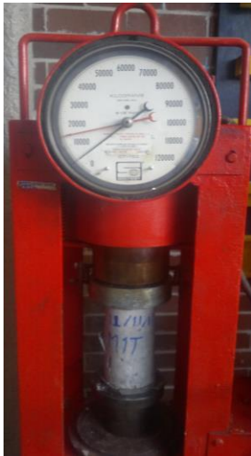
Fotografía 28 (muestra resultado a 7 días de 15200kg)
