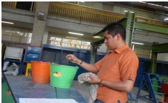
Fotografía 14 (muestra el procedimiento para ver la grava en estado SSS)
