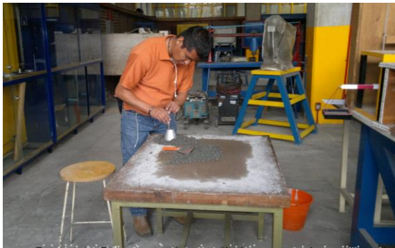
Fotografía 7 (muestra el procedimiento para determinar el estado SSS de la arena)
