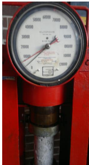
Fotografía 56 (muestra resultado a 28 días de 8300kg)
