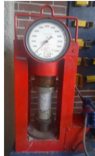
Fotografía 46 (muestra resultado a 28 días de 1400kg)
