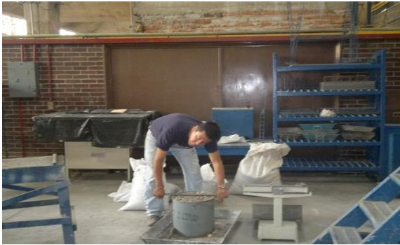
Fotografía 12 (Muestra la colocación en un molde la grava seca para posteriormente determinar la densidad de la grava)
