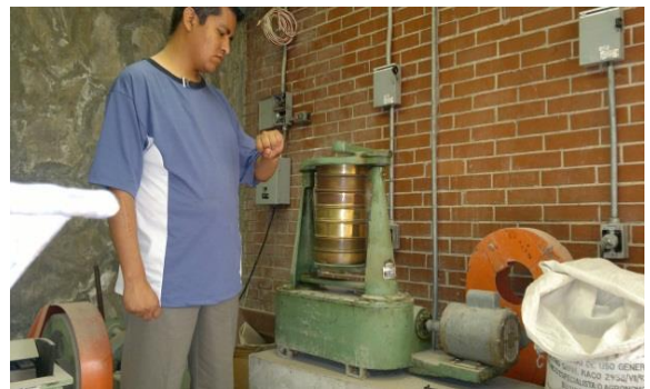
Fotografía 19 (muestra la grava en las mallas para determinar su tamaño máximo de agregado)
