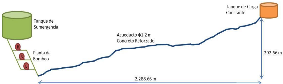
FIGURA 5. 1 PERFIL DEL ACUEDUCTO A BOMBEO
