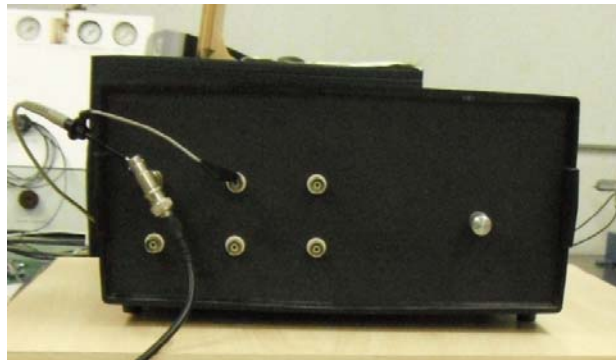
Figura 3.21 Generador de funciones senoidales fabricado por la Coordinación de Instrumentación del Instituto de Ingeniería
