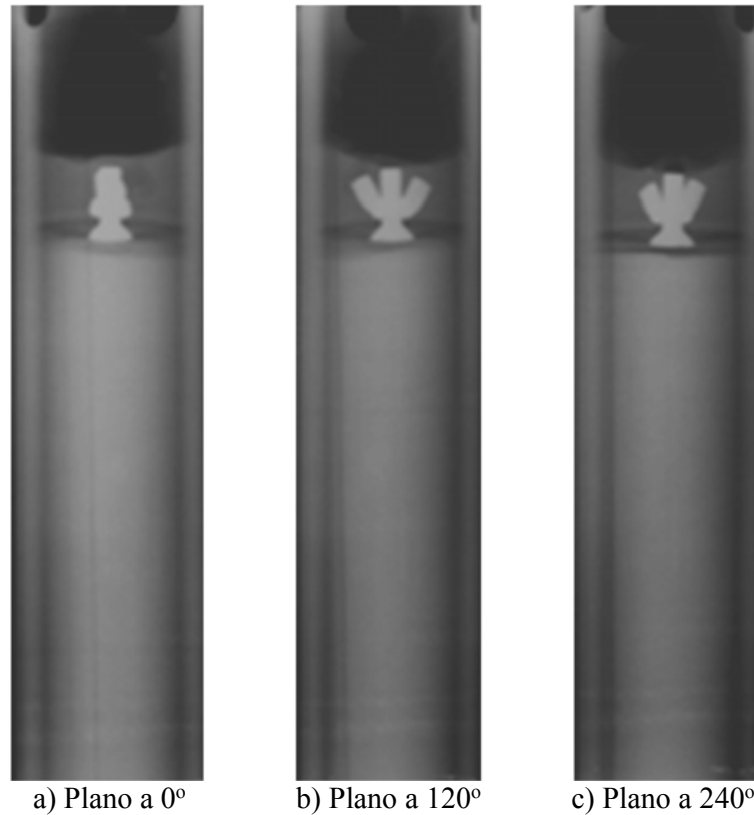
Figura 4.2 Radiografía de rayos X de una muestra de suelo contenida en tubo de pared delgada en tres planos a 0^\circ , 120^\circ y 240^\circ .
