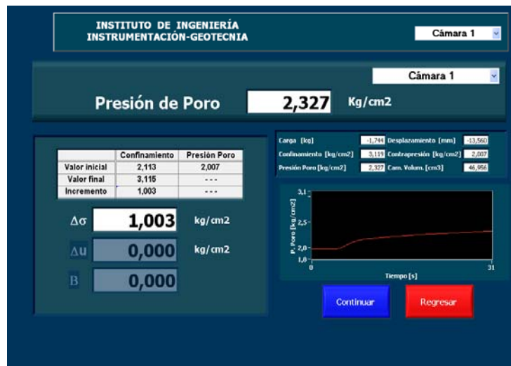
Figura 3.9 Medición del parámetro B de Skempton
