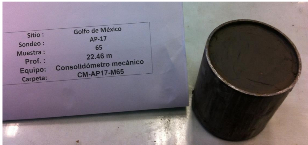
Figura 3.2.8. Probeta experimental de 80 mm de altura y 69 mm de diámetro, para un suelo marino
