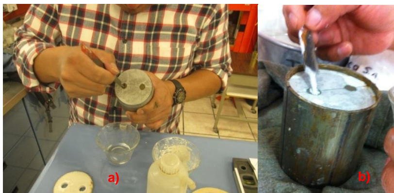
Figura 4.4.3.- Montaje de la muestra. a) Realizando el ranurado y b) colocando la mezcla de agua con bentonita.
