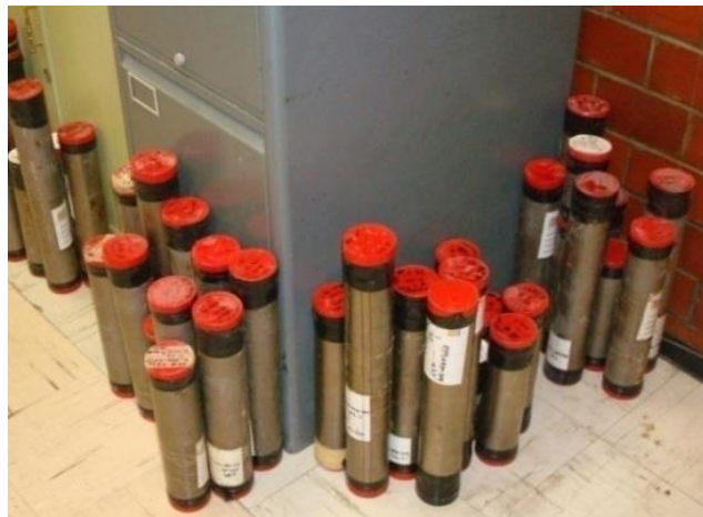
Figura 4.2.2.- Muestras recuperadas de sondeos AP-13 a AP-17
