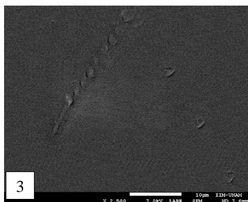
Figura 4. 23. SEM, (A) micrografías de las películas de polietileno a los 68 días en el proceso de compostaje, a 5 kV. (B) micrografías topográficas de las películas de polietileno a los 68 días en el proceso de compostaje, a 7 kV.
