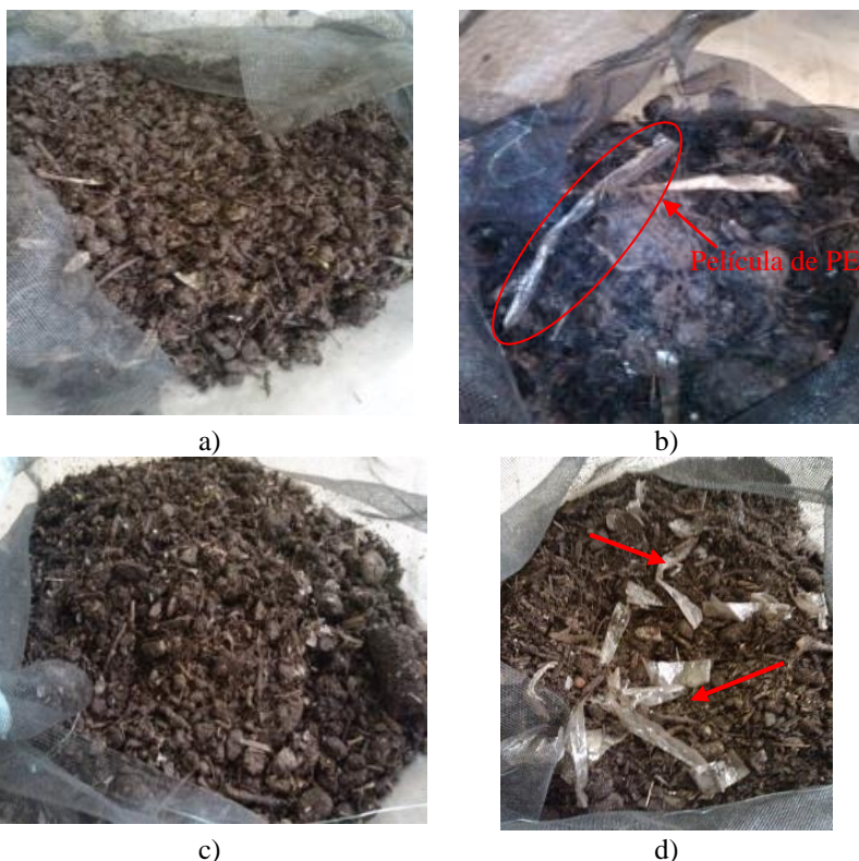
Figura 4. 4. Fotografías del cambio por el proceso de compostaje a los días: 55 a) polietileno con aditivo y b) polietileno sólo y al día 65 c) polietileno con aditivo y d) polietileno sin aditivo.
