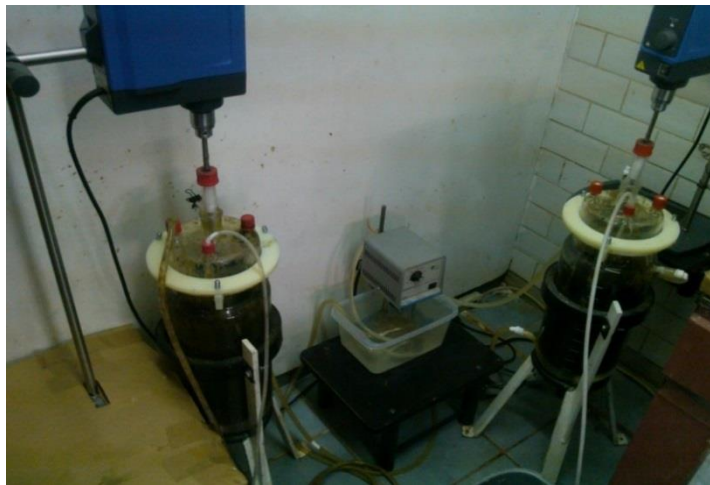
Figura 10. Reactores anaerobios en serie, conectados a un recirculador.
