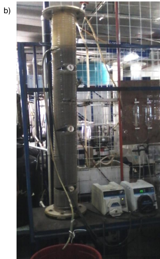
Figura 3.1 Sistemas experimentales: a) Diagrama experimental del reactor UASB, b) Fotografía del reactor UASB.
