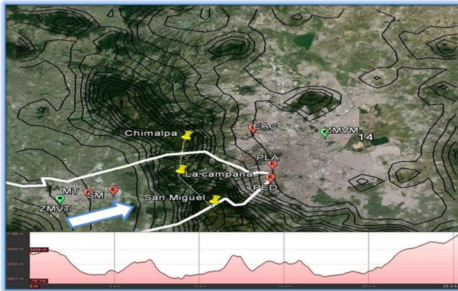
Figura A-55: Trayectoria de vientos a estación PED y PLA día 120, perfil del alturas visto desde la ZMVT.
