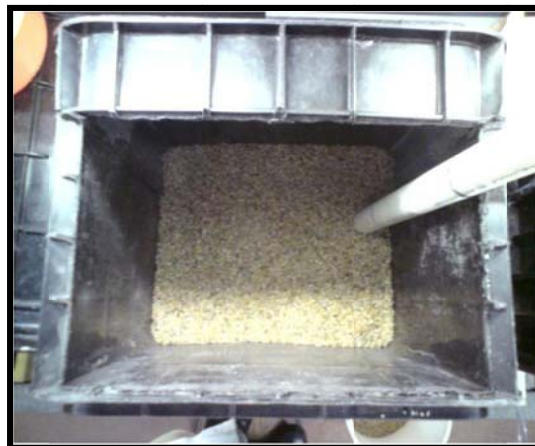
Figura A3-10. Proceso de empacado del sistema HACEH.
