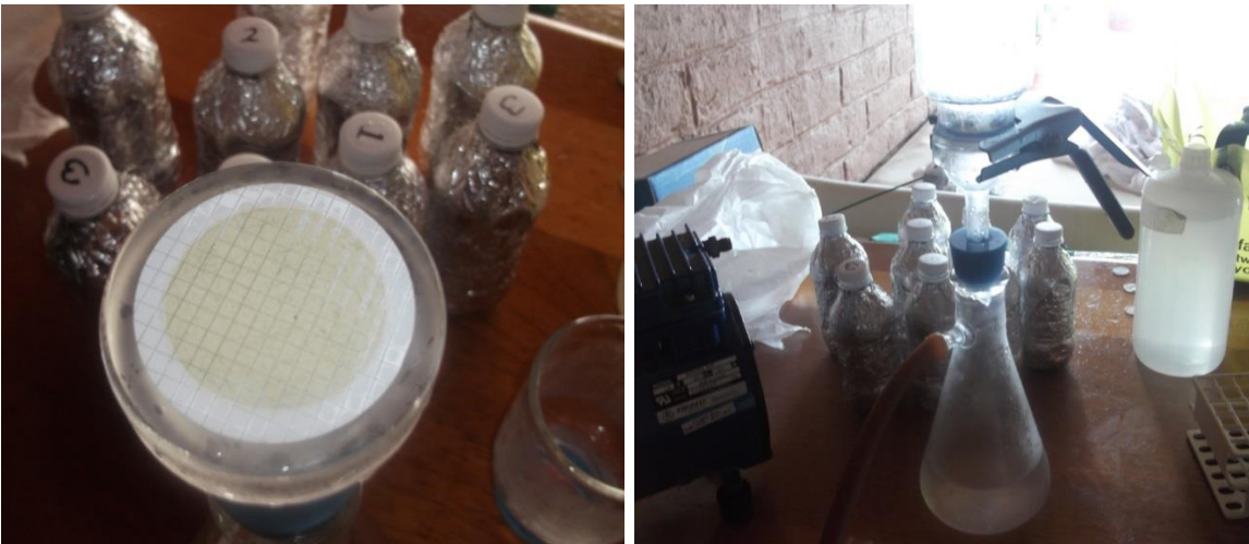
Figura 17. Filtración de muestras
