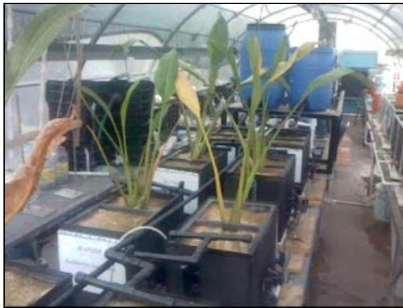
Figura 11. Reactores conectados a los tanques de alimentación.
