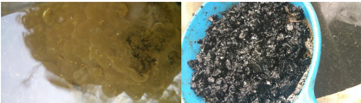
Figura 38. Fotografía de la superficie de la cama de empaque con biomasa (izquierda) y lodo con probable recubrimiento de óxidos de hierro (derecha)
