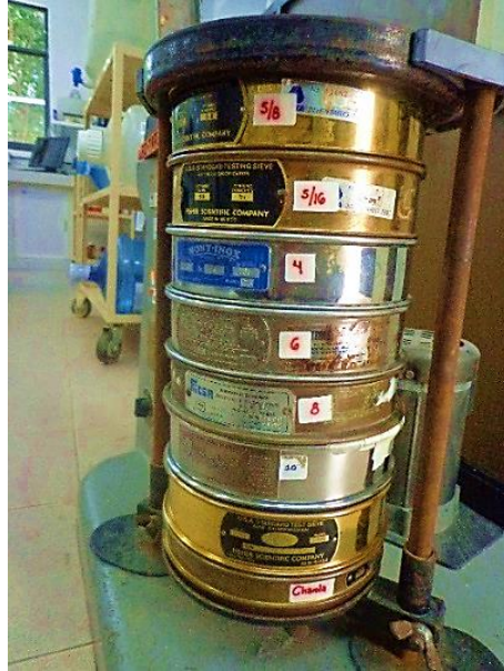
Figura 14. Agitador mecánico con juego de tamices ASTM colocados de mayor a menor abertura
