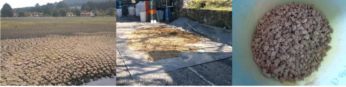
Figura 13. Acondicionamiento del Lodo-Al. Depósito de lodos secos en la planta Los Berros (izquierda). Secado del lodo-Al al aire (centro) y lodo-Al después del secado y tamizado (derecha)
