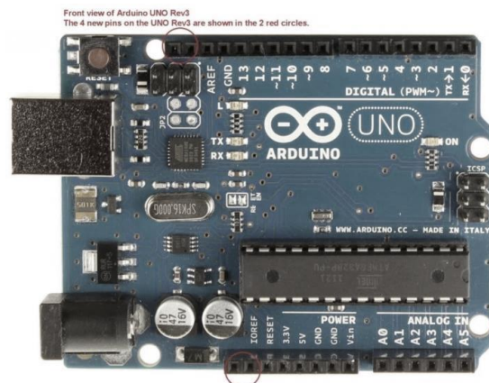
Fig. 2.37: Arduino UNO R3
