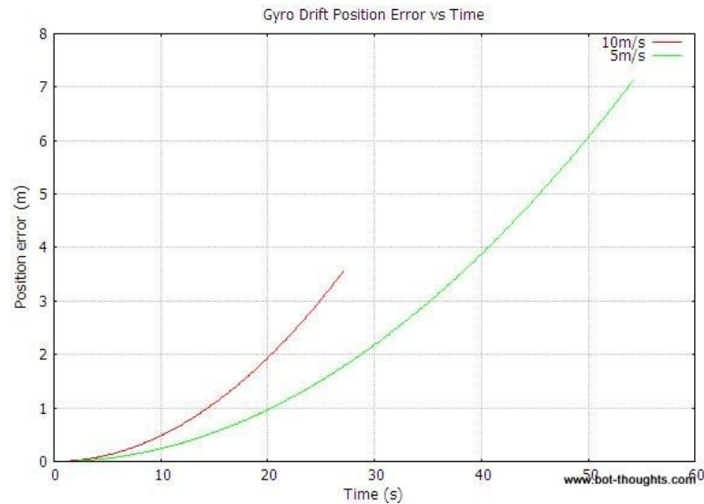
Figura 5.1: Error acumulado en las lecturas de un giroscopio.
