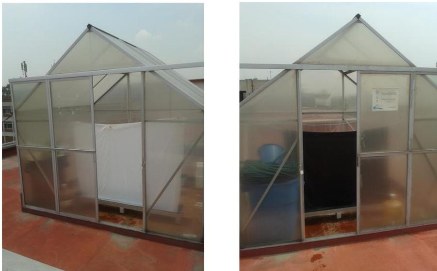
*Figura 8.6. Casetas de destilación solar Experimento 1*
