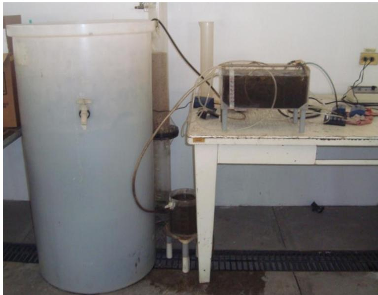
**Figura 4.1 Sistema experimental utilizado para observar el desarrollo de la biopelícula y para la implementación de técnicas de su caracterización.**
