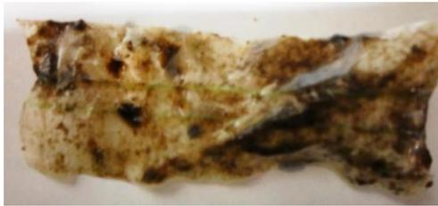
Figura 4. Fotografía del empaque de uno de los reactores con biopelícula.
