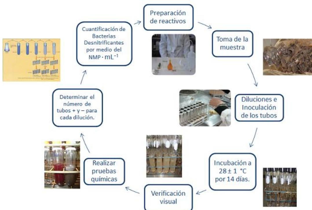
**Figura 4.4. Diagrama del procedimiento utilizado para la cuantificación de las bacterias desnitrificantes.**
