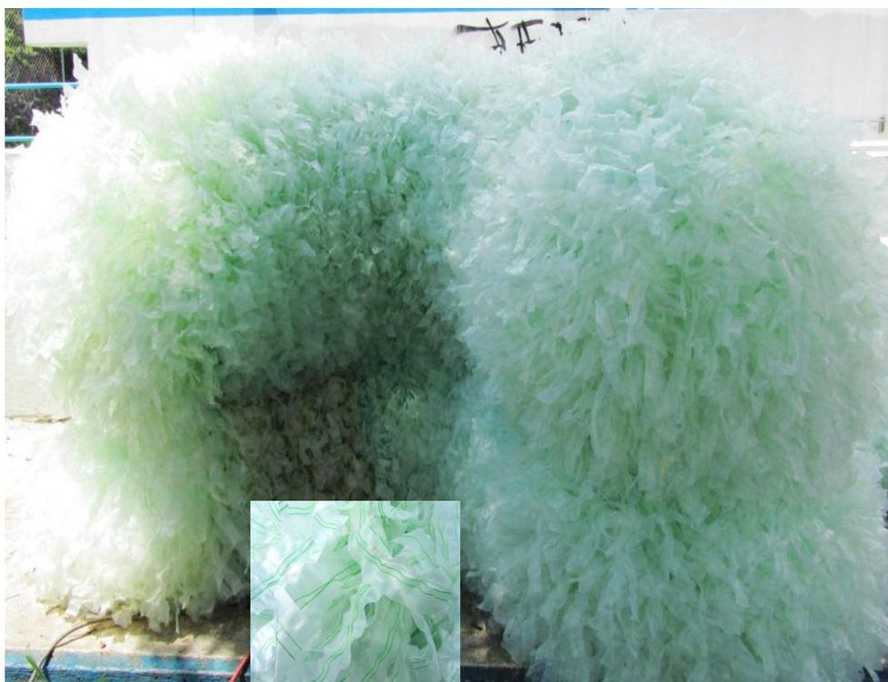
**Figura 3.11** Fotografía de la cinta y el empaque utilizado en los reactores.
