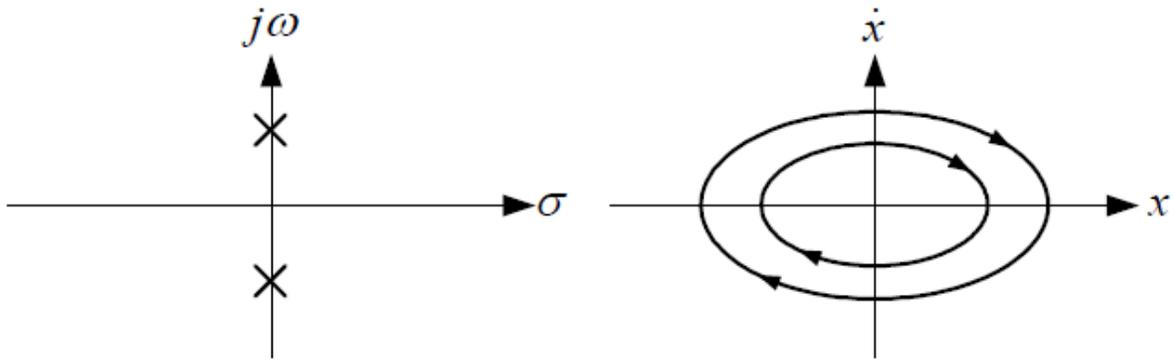
Figura 1.3: Comportamiento oscilatorio de un centro
