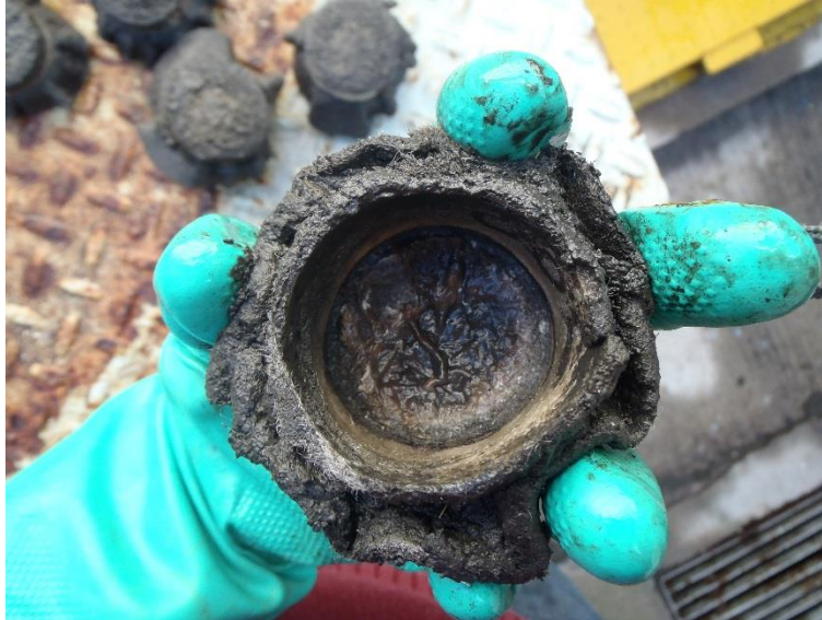
Figura 4.3 Película formada durante la operación del lado del permeado
