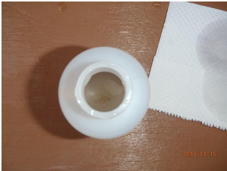
Figura 4.4 Sólidos macroscópicos en una muestra de permeado
