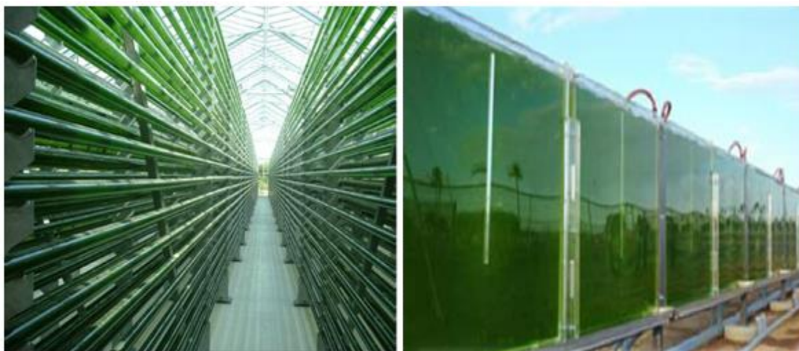
Figura 9. Diseños de fotobioreactores cerrados: tubular horizontal (Abdel-Raouf et al., 2012) (imagen izquierda) y placa plana (Muñoz, 2013) (imagen derecha)
