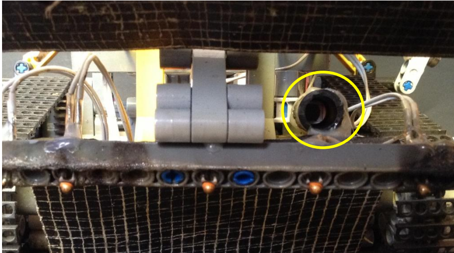
Figura 169. Posición del sensor PIR en la parte frontal.
