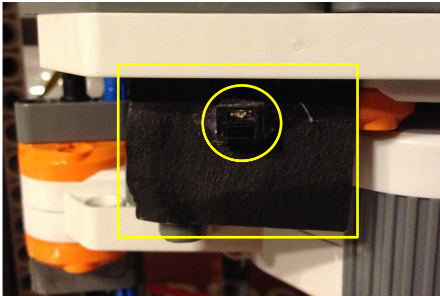
Figura 129. Propuesta de una barrera física (rectángulo) para mantener las condiciones de luminosidad del sensor QRD1114 (círculo) constantes.
