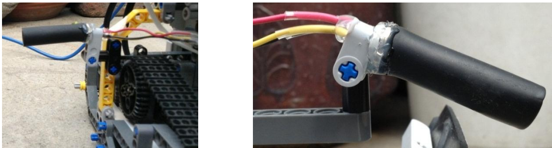
Figura 124. Piezas de Lego utilizadas para sujetar los sensores PIR.
